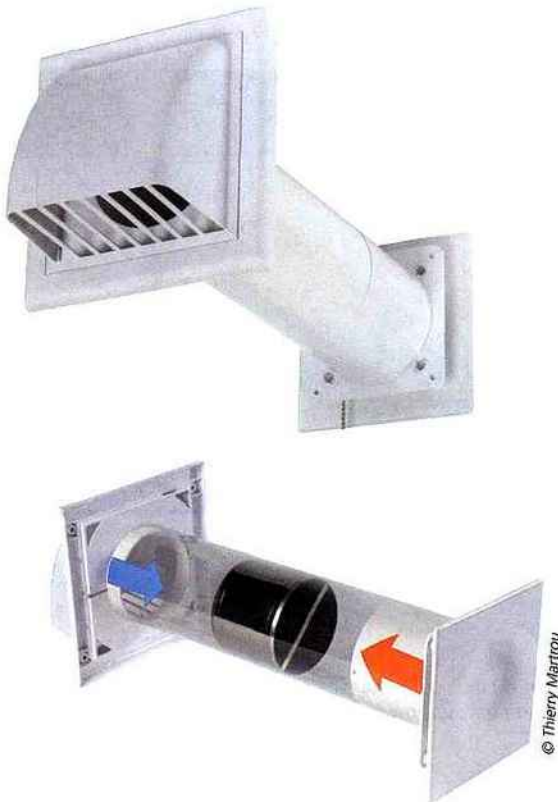
Mono double flux Cassio, d'Autogyre, renouvelle l'air tout en récupérant 90 % de l'énergie qu'il contient, grâce à un échangeur thermique.
