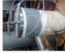
Mesure du taux d'émission des principaux matériaux avec une cellule FLEC®. L'objectif est de remplacer les matériaux les plus émissifs.
