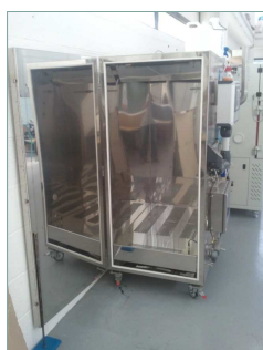
Chambre climatique 1 m 3 (crédit photos : J.Nicolle)
