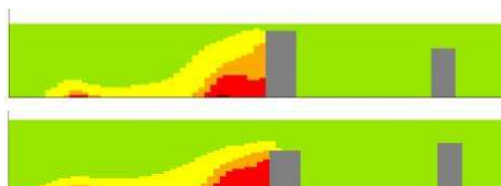
Figure 3 : Coupe transversale selon l'axe 5 avec la configuration actuelle du bâti (en haut) et une réduction de la hauteur du bâti coté rue (en bas).
