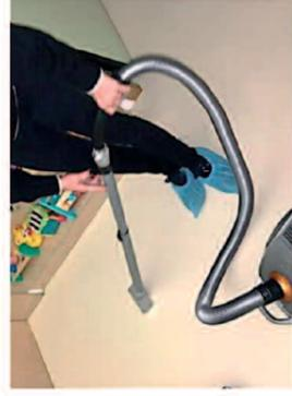
Prélèvement par aspiration de poussières déposées au sol
