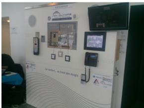
Sur un mur, la maquette semi-numérique interactive présente et vérifie la compatibilité des solutions techniques du futur bâtiment (domotique, système de détection de chutes, appel malade, contrôle d'accès, etc.) répondant au besoin d'un maître d'ouvrage. L'outil est utilisé dès la phase conception pour déterminer les solutions applicables à un projet, spécifiquement les EPHAD, et en exploitation pour la gestion des systèmes et l'information des usagers.
